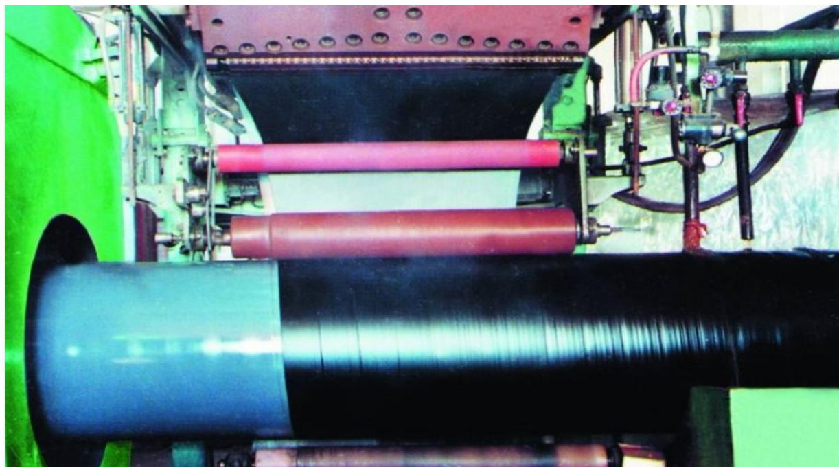
三层PE生产线 , 3PE , 3PE生产线。
