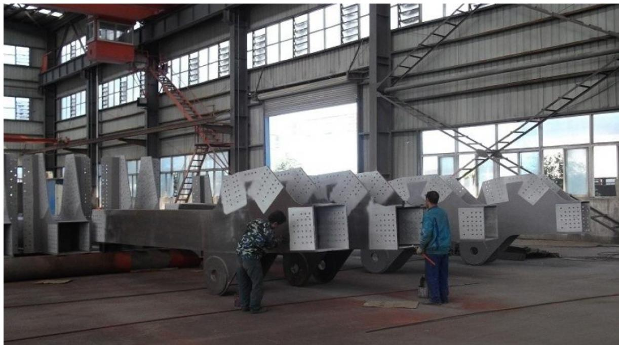
飞云江五桥杆件喷铝完毕 油漆作业施工。
